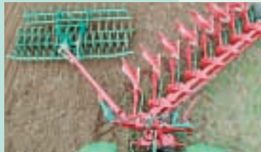
Der leichte Packer stützt den Pflug ab, überträgt dessen Gewicht auf den Boden und bereitet im gleichen Arbeitsgang das Saatbett.
