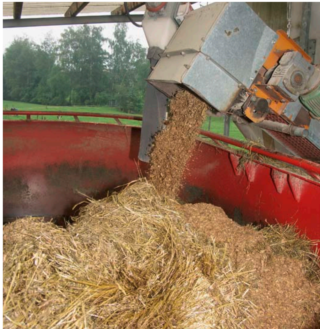
Bei Einsatz von Fütterungstechnik (Silofräsen, Mischwagen etc.) darf die vorhandene Strukturwirksamkeit nicht durch die mechanische Beanspruchung zerstört werden.
