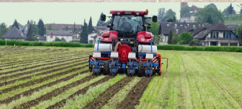
Gute Tragfähigkeit und Erosionsschutz mit Streifenfrässaat
